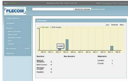
*Cette passerelle SMS possède un module GSM ainsi qu'une interface d'administration type Web accessible par tout ordinateur/tablette/téléphone connecté au réseau.*
